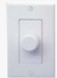
LSP 1460 Entrada: 100V – 60W RMS Atenuação: 4 passos + OFF Controle de prioridade: 24VDC
